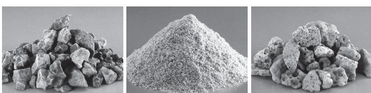
左から、製鋼スラグ、高炉水碎スラグ、高炉徐冷スラグ。
