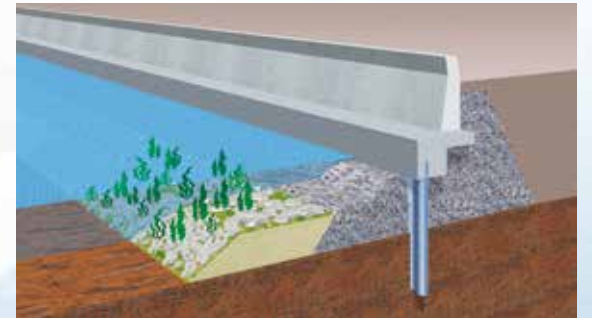
カルシア改質土（カルシア改質材で固めた泥）で光が届く浅い場所を作る
