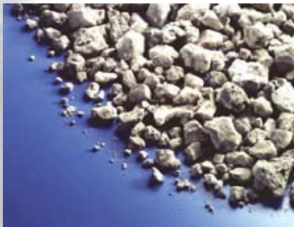
▲転炉スラグの外観
